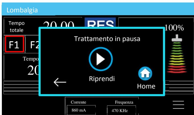
Ogni volta che il trattamento verrà sospeso, la potenza verrà azzerata. Se si sceglie di riprendere il trattamento sarà necessario aumentare nuovamente la potenza.
