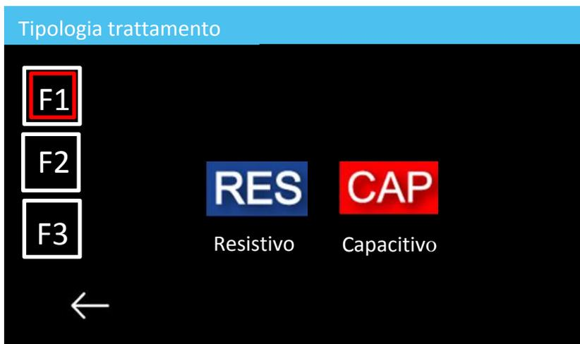
Per ognuna delle fasi sarà possibile scegliere se utilizzare la modalità capacitiva o resistiva e impostare la frequenza e la durata della fase.
